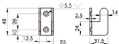
**9000 | Support fermé** pour barre de sécurité de section 14mm, carte de 2 pièces / A.Z
