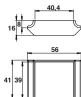
**Pièce de raccordement pour 40x40 mm sur tube 30x30 mm**
