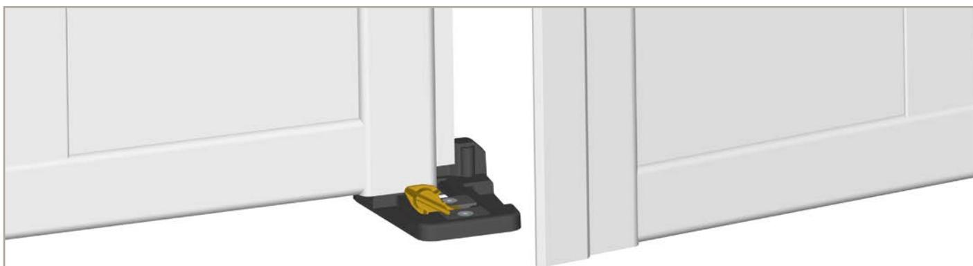
Verrouillage et déverrouillage des vantaux à l'aide du pied.
