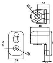
Paumelle zamak avec bague polyamide Ø12
