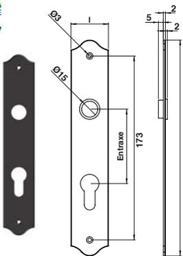
**Entrée simple aluminium l35 avec bague polyamide**
