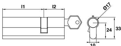
Cylindre double laiton nickelé
