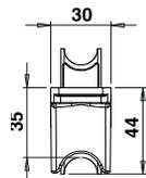
Chape compacte sur galet U Ø63 acier zingué pour rail Ø16
