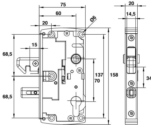
➤ Serrure seule pêne levant à crochet avec butée antisoulèvement axe 60 - Entraxe 70
