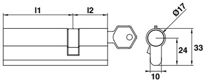
Cylindre double laiton nickelé
