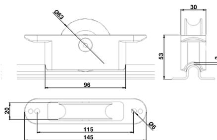
Chape semi-encastée sur galet U Ø63 inox pour rail Ø16
