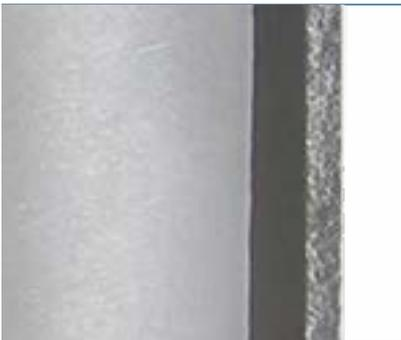
Procédé qui consiste à déposer une couche de chrome sur des pièces par trempage dans un bain électrolytique : le chrome dissout dans le bain est transféré sur les pièces par l'effet d'un courant électrique.
